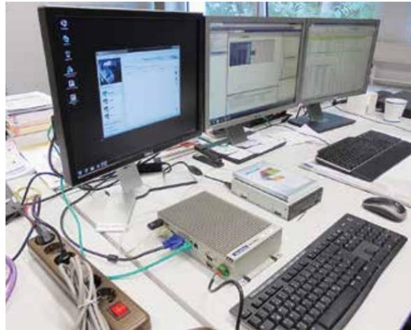
Das neue Prozessdatenerfassungssystem soll dazu die Daten des Wicklers über geeignete Schnittstellen erfassen und so erweiterbar sein, dass eine spätere Integration der übrigen Komponenten der Extrusionsanlage möglich ist.
